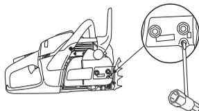
Цепь считается натянутой правильно, если она свободно проворачивается рукой. После этого, удерживая носок пильного полотна в верхнем положении, затяните гайки крепления пильного полотна универсальным ключом.
