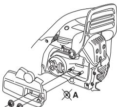
Установите пильное полотно на специально предназначенные болты. Установите полотно в самое заднее положение. Наденьте цепь на ведущую звездочку и вставьте ее хвостовики в паз пильного полотна. Начиная с верхней стороны пильного полотна.
