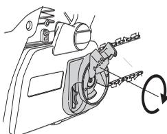
При установке новой цепи следует часто проверять ее натяжение, пока цепь не приработается. Регулярно проверяйте натяжение цепи. Правильно натянутая цепь обеспечивает высокое качество пиления и дольше служит.
