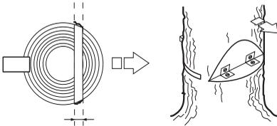
Возможность влияния на направление падения будет полностью утрачена, если полоса разлома слишком узкая или пропилована направляющий и основной пропилы плохо размещены.
