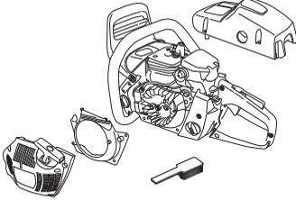
Производите очистку системы охлаждения щеткой раз в неделю или чаще, если этого требуют условия работы. Загрязненная или засоренная система охлаждения может привести к перегреву машины и вызвать повреждение поршня и цилиндра.
