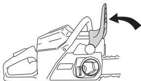
Снимите ручку и колпак сцепления (тормоз цепи). Снимите транспортировочное кольцо.
