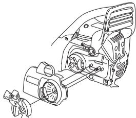
Установите пильное полотно на специально предназначенные болты. Установите полотно в самое заднее положение. Наденьте цепь на ведущую звездочку и вставьте ее хвостовики в паз пильного полотна. Начинайте с верхней стороны пильного полотна.
