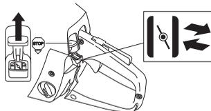
**Газ запуска:** Правильное положение комбинации блокировки/газа запуска устанавливается переводом ручки в указанное выше положение.
