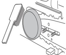
Регулярно проверяйте, чтобы лента тормоза была по крайней мере толщиной минимал 0.6 мм в самом изношенном месте.
