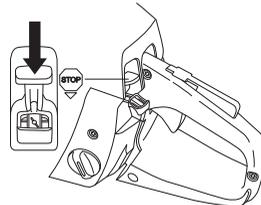
Двигатель останавливается путем выключения зажигания.
