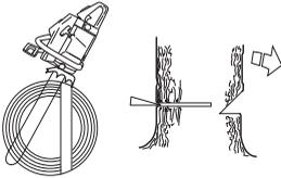
Закончить основной пропил нужно параллельно линии направляющего пропила так, чтобы расстояние между ними составляло около 1/10 диаметра ствола. Нераспиленный участок ствола называется полоса разлома (недопил).
