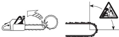
Отдача всегда происходит в плоскости резания пилы. Обычно при отдаче моторную пилу отбрасывает назад и вверх в направлении рабочего. Тем не менее моторная пила в момент отдачи может двигаться в различных направлениях в зависимости от метода резки, который применялся в момент касания зоны отдачи полотна и объекта.
