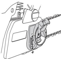
Цепь натянута правильно, если она не провисает под направляющей, но ее можно свободно провернуть вручную. Придерживая носовую часть направляющей, затяните ее сцепление, поворачивая ручку по часовой стрелке.
