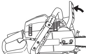
Отвинтите гайки крепления пильного полотна и снимите крышку муфты сцепления (тормоза цепи). Снимите транспортировочное кольцо (A).
