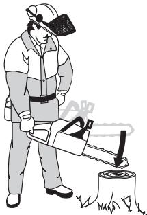
При прикосновении пильного полотна к пню должен сработать тормоз.
