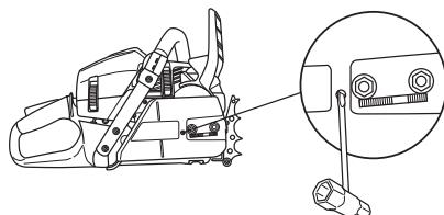
Цепь считается натянутой правильно, если она свободно проворачивается рукой. После этого , удерживая носок пильного полотна в вверхнем положений, затяните гайки крепления пильного полотна универсальным ключом.
