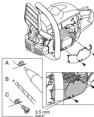
**ВНИМАНИЕ!** Если для повышения рабочей температуры двигателя применяются специальные приспособления для работы в зимних условиях, необходимо заново отрегулировать все характеристики машины, установленные для работы в нормальных условиях. В противном случае может произойти перегрев двигателя, что приведет к его серьезным повреждениям.
