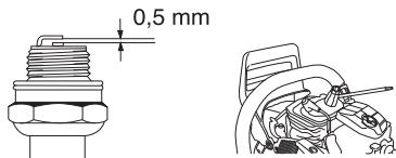
Обратите внимание! Всегда используйте только указанный тип свечи! Применение несоответствующей модели может привести к серьезным повреждениям поршня/цилиндра. Следите за тем, чтобы свеча была оснащена т.н. изоляцией радиопомех.
