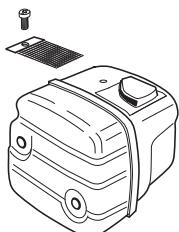
Глушитель служит для снижения уровня шума и отвода раскаленных выхлопных газов от рабочего. Выхлопные газы очень горячие и
