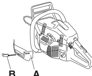
Они уменьшают доступ холодного воздуха и предохраняют от попадания большого количества снега в пространство карбюратора. Обратите внимание! При установленной зимней пробке крышка должна быть открытой!
