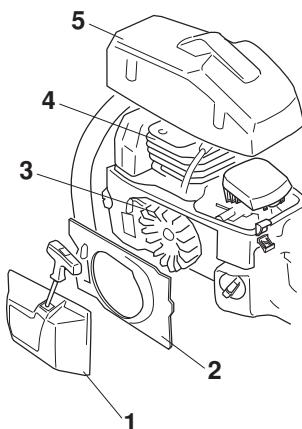
Производите очистку системы охлаждения щеткой раз в неделю или чаще, если этого требуют условия работы. Загрязненная или засоренная система охлаждения может привести к перегреву машины и вызвать повреждение поршня и цилиндра.
