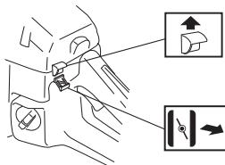
Если машина оборудована декомпрессионным клапаном (A): Его необходимо нажать, чтобы уменьшить давление в цилиндре и облегчить запуск машины. При запуске машины всегда пользуйтесь декомпрессионным клапаном.
