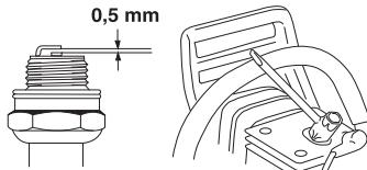
Обратите внимание! Всегда используйте только указанный тип свечи! Применение несоответствующей модели может привести к серьезным повреждениям поршня/цилиндра. Следите за тем, чтобы свеча была оснащена т.н. изоляцией радиопомех.
