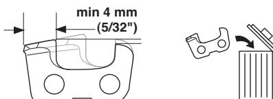
Общие сведения относительно снижения ограничителя глубины врезания.
