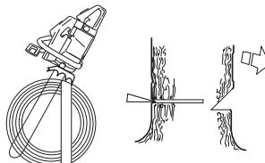
Закончить основной пропил нужно параллельно линии направляющего пропила так, чтобы расстояние между ними составляло около 1/10 диаметра ствола. Нераспиленный участок ствола называется полоса разлома (недопил). Полоса разлома действует как петельный щарнир, задающий направление падения дерева.
