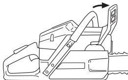
**Зажигание:** Установите переключатель зажигания в левое положение.
