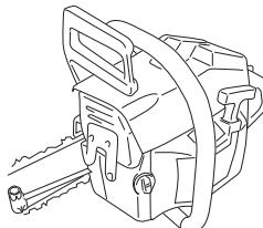
Цепь считается натянутой правильно, если она свободно проворачивается рукой. После этого , удерживая носок пильного полотна в вверхнем положении, затяните гайки крепления пильного полотна универсальным ключом.
