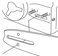
Для этого поверните винт механизма регулировки цепи по часовой стрелке. Цепь следует натягивать до тех пор, пока она не будет плотно прилегать к нижней стороне пильного полотна.
