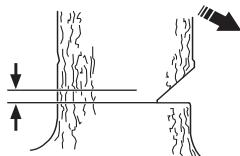
Вставьте зубчатый упор (если установлен) сзади надреза. Работайте на полном газу и вводите пильное полотно в ствол дерева постепенно, плавным движением. Следите за
