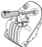
В некоторых глушителях предусмотрен специальный искрогаситель. Если ваша машина оборудована таким глушителем, сетку фильтра следует чистить раз в неделю. Наилучшие пользуются стальной щеткой. Забитая решетка приводит к работе с горячим двигателем, что дает серьезные повреждения двигателя.
