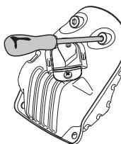
В некоторых глушителях предусмотрен специальный искрогаситель. Если ваша машина оборудована таким глушителем, сетку фильтра следует чистить раз в неделю. Наилучше пользоваться стальной щеткой. Забитая решетка приводит к работе с горячим двигателем, что дает серьезные повреждения двигателя. Обратите внимание! В случае повреждения сетку следует заменить. При засоренной сетке машина может перегреться, что приведет к
