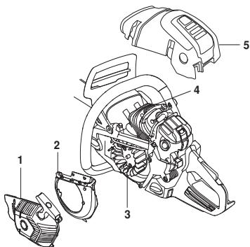
Производите очистку системы охлаждения щёткой раз в неделю или чаще, если этого требуют условия работы. Загрязненная или засоренная система охлаждения может привести к перегреву машины и вызвать повреждение поршня и цилиндра.
