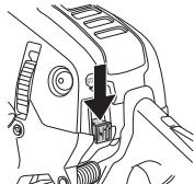
**ПОМНИТЕ!** Выключатель Запуск/Остановка автоматически переходит рабочее положение. В целях избежания непроизвольного запуска, головка свечи должна быть всегда снята со свечи когда вы оставляете машину без присмотра.
