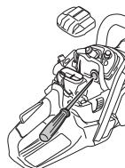
Для температуры ниже -5°C и/или в условиях снегопада предусмотрена специальная крышка, укрепленная на корпусе стартера.
