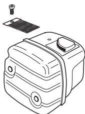
Глушитель служит для снижения уровня шума и отвода раскаленных выхлопных газов от рабочего. Выхлопные газы очень горячие и могут содержать искры, что может привести к
