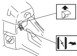
**Топливный насос:** Если машина укомплектована топливным насосом (A): Сожмите несколько раз резиновую грушу топливного насоса пока в нее не начнет поступать топливо. Грушу нет необходимости заполнять полностью.
