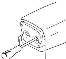
В некоторых глушителях предусмотрен специальный искрогаситель. Если ваша машина оборудована таким глушителем, сетку фильтра следует чистить раз в неделю. Наилучшие пользуются стальной щеткой. Забитая решетка приводит к работе с горячим двигателем, что дает серьезные повреждения двигателя.
