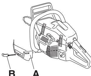
Они уменьшают доступ холодного воздуха и предохраняют от попадания большого количества снега в пространство карбюратора. Обратите внимание! При установленной зимней пробке крышка должна быть открытой!
