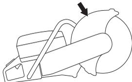
Проверка состояния режущего диска и его щитка.
