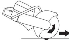
Не передвигайте машину, если резчик вращается. Гироскопические силы могут затруднить движение в выбранном направлении.
