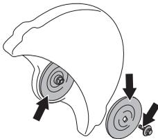
Используйте только фланцевые шайбы, поставляемые компанией Husqvarna, мин. диаметр 105 мм/4,1 дюйма.
