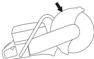
Проверка состояния режущего диска и его щитка.
