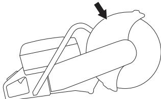
Проверка состояния режущего диска и его щитка.
