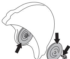
Не пользуйтесь фланцевыми шайбами с перекосом, со сбитыми краями, со следами ударов или грязными. Не пользуйтесь фланцевыми шайбами разных размеров.
