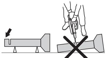
Если труба проседает по время резки и пропил закрывается, происходит заклинивание режущего диска в зоне отдачи. Это может привести к очень сильной отдаче. Если обеспечена правильная опора, концы труб переместятся вниз и пропил раскроется, предотвращая заклинивание режущего диска.
