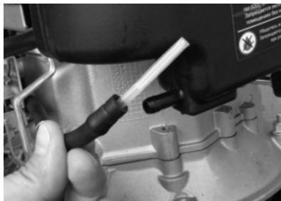
Рис. 17 Обслуживание топливного фильтра
