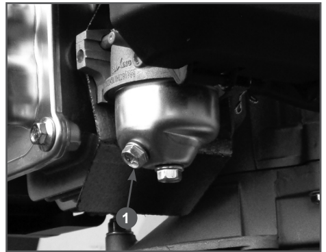
Рис. 19 Слив топлива из карбюратора
