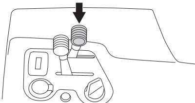
При "холодном" пуске двигателя отведите ручку регулятора назад до упора.
