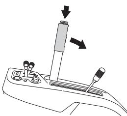
Этот рычаг можно также использовать для временного регулирования высоты резки, например на небольшом бугре на газоне.
