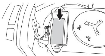
**ВАЖНО!** Никогда не включайте двигатель со снятым воздушным фильтром! Не пропитывайте фильтры маслом. Они должны монтироваться сухими.
