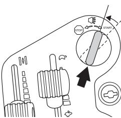
**ВАЖНО!** Не держите стартер в рабочем положении более 5 секунд. Если двигатель не заводится, подождите примерно 15 секунд перед попыткой повторного запуска.
