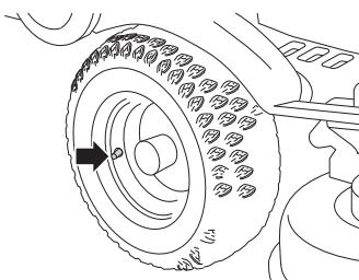
**ВАЖНО!** Для того чтобы достичь наилучшей производительности, а также избежать повреждения машины, необходимо, чтобы давление в шинах было одинаковым.
