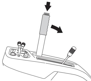
**ВАЖНО!** Срок службы приводных ремней значительно увеличивается, если двигатель работает на низких оборотах, когда включены ножи. Поэтому давайте полный газ тогда, когда режущий блок будет опущен в положение стрижки.
