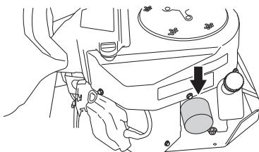
Нанесите на резиновую прокладку нового фильтра небольшое количество нового масла. Смонтируйте масляный фильтр, повернув его по часовой стрелке. Поворачивайте усилием руки, пока резиновая прокладка не будет прилегать. Затяните потом еще на пол оборота.
