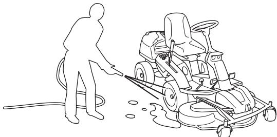
**ВАЖНО!** Перед проведением работ по техническому обслуживанию всегда паркуйте машину на ровной поверхности с ВЫКЛЮЧЕННЫМ двигателем.
