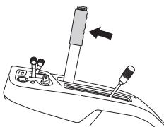
Если нажать на кнопку фиксации и перевести рычаг вперед, то рабочий узел начнет опускаться, и ножи автоматически начнут вращаться (положение стрижки).
