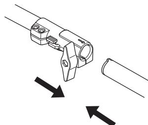
Перед использованием узла, хорошо затяните ручку.
