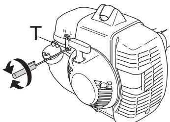
**ПРЕДУПРЕЖДЕНИЕ!** Если холостые обороты невозмож но отрегулировать так, чтобы режущее оборудование стояло неподвижно, обращайтесь к продавцу/в мастерскую. Не пользуйтесь машиной, пока не будет выполнена точная регулировка или ремонт.
