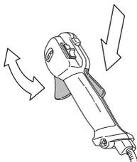
См. указания в разделе Запуск. Включите машину и полностью откройте дроссель. Отпустите рычаг дросселя и удостоверьтесь, что режущее оборудование останавливается и остается неподвижным. Если после постановки дросселя в положение холостого хода режущие оборудование продолжает вращаться, следует проверить регулировку холостого хода карбюратора. См. указания в разделе Техническое обслуживание.
