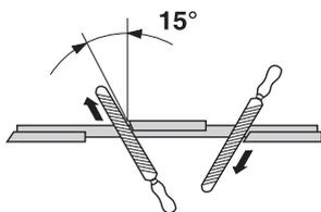
Отрегулируйте разводку. Она должна составлять 1 мм.
