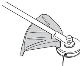
Проверьте, чтобы защита не была повреждена и чтобы на ней не было трещин. Замените защиту, если она была подвержена удару или если на ней есть трещины.
