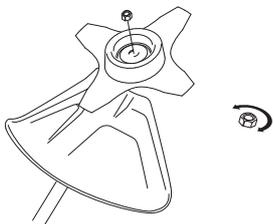
При ослаблении и затягивании гайки лезвия для пиления, рука может быть травмирована зубьями лезвия. Старайтесь, чтобы при этой работе ваша рука всегда была защищена щитком лезвия. Эта задача облегчается за счет использования длинного торцевого ключа. На иллюстрации стрелкой показан участок, в котором следует располагать торцевой ключ при ослаблении и затягивании гайки.
