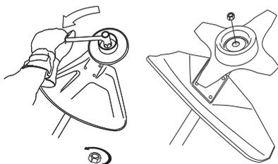
Нейлоновая прокладка контргайки не должна быть изношена настолько, чтобы ее можно было поворачивать вручную. Прокладка должна выдерживать усилие минимально 1,5 Нм. Гайку следует заменить после ее использования приблизительно 10 раз.
