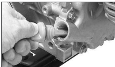
Рис. 5 Проверка уровня масла в картере
