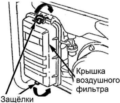
Рис. 14 Снятие крышки воздушного фильтра
