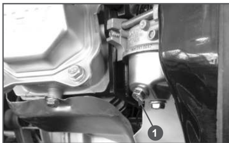
Рис. 20 Слив топлива из карбюратора 1. Болт сливной
