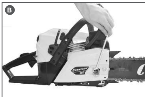
Рис. 5 Затяжка гайки крепления шины
