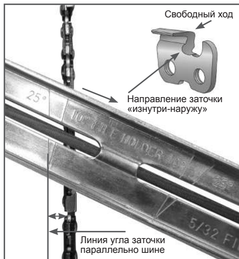
Рис. 22 Расположение линии угла заточки
