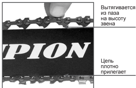
Рис. 6 Регулировка натяжения цепи
