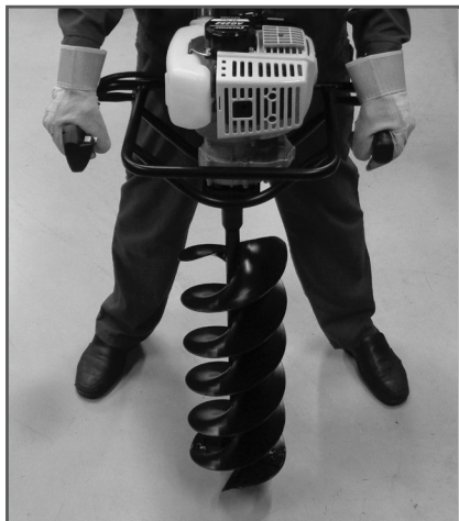
Рис. 8 Положение тела оператора при работе мотобуром
