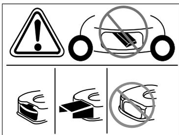
Опасность травмирования – работать только с установленным выбрасывателем.
