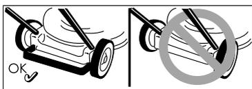
Опасность травмирования – работать только с установленной скобой безопасности.
